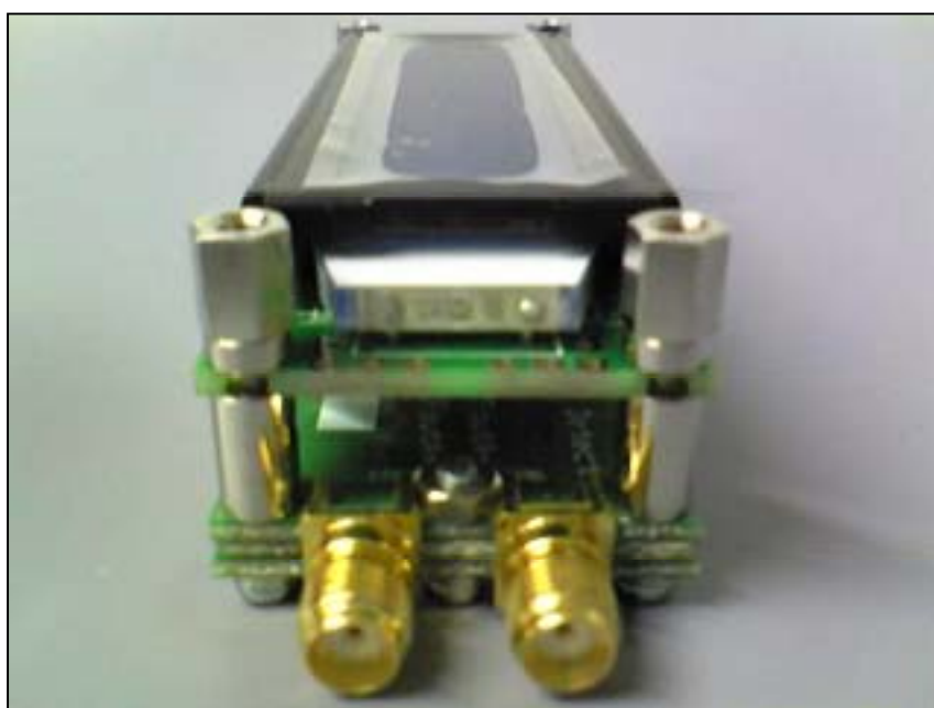
Fig.10 液晶表示面の4隅の取り付けネジ穴はM3(ほかのネジはM2.6)
