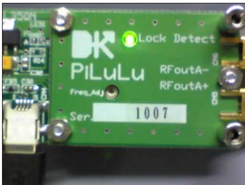
Fig.8 ロック表示用LED(Lock Detect)と基準周波数調整用穴(Freq_Adj)
