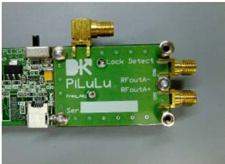
Fig.9 出力ポート(CN5、CN6)はSMAジャック(写真は差動出力モデル)
