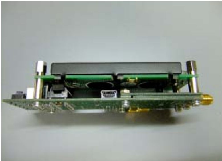
Fig.3 スタックの様子(上段の基板は液晶表示器)
