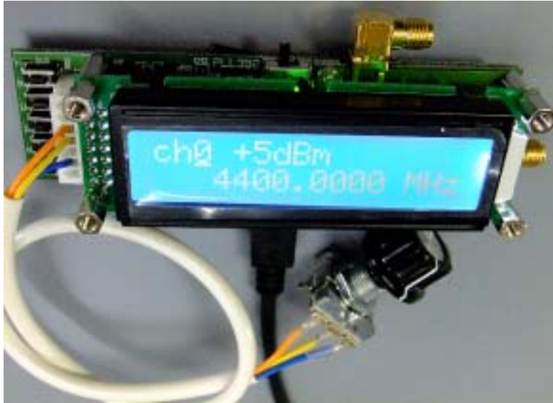
Fig.1 「ぴるる」PLL352シリーズ(上部の直角形SMAジャックが外部同期入力用CN7) 同期入力切替スライドスイッチSW6を左に切り替えると、内部同期となり、内部同期表示用のLED1(液晶表示器の後ろ)が点灯し、右に切り替えると、外部同期となり、LED1は消灯する。
