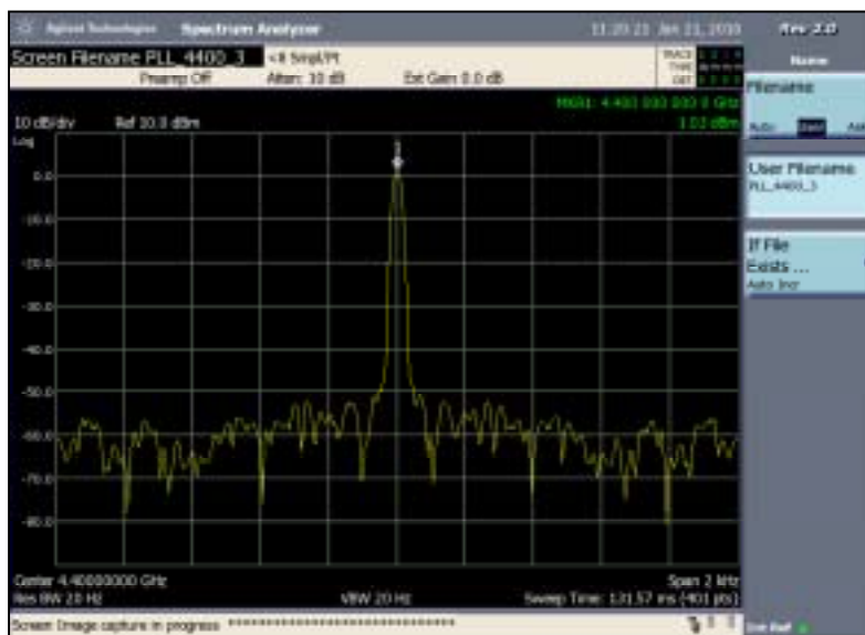
Fig.11 4400MHzの近傍スペクトラム(外部同期信号は+5dBm、Span=2kHz、RBW=20Hz)
