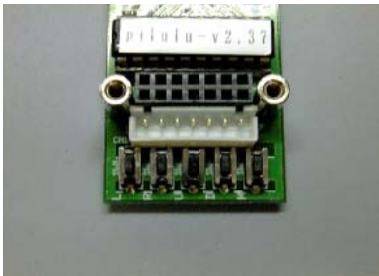
Fig.7 5個の押しボタンスイッチとCN1(白)、その上がCN2(黒:液晶表示器用ソケット)
