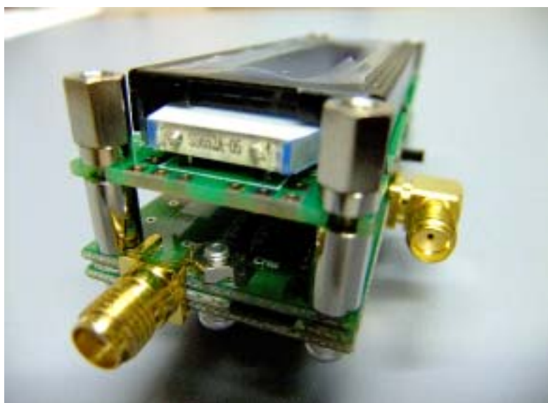
Fig.9 出力ポート(CN5、CN6)はSMAジャック(写真は差動出力モデル)
