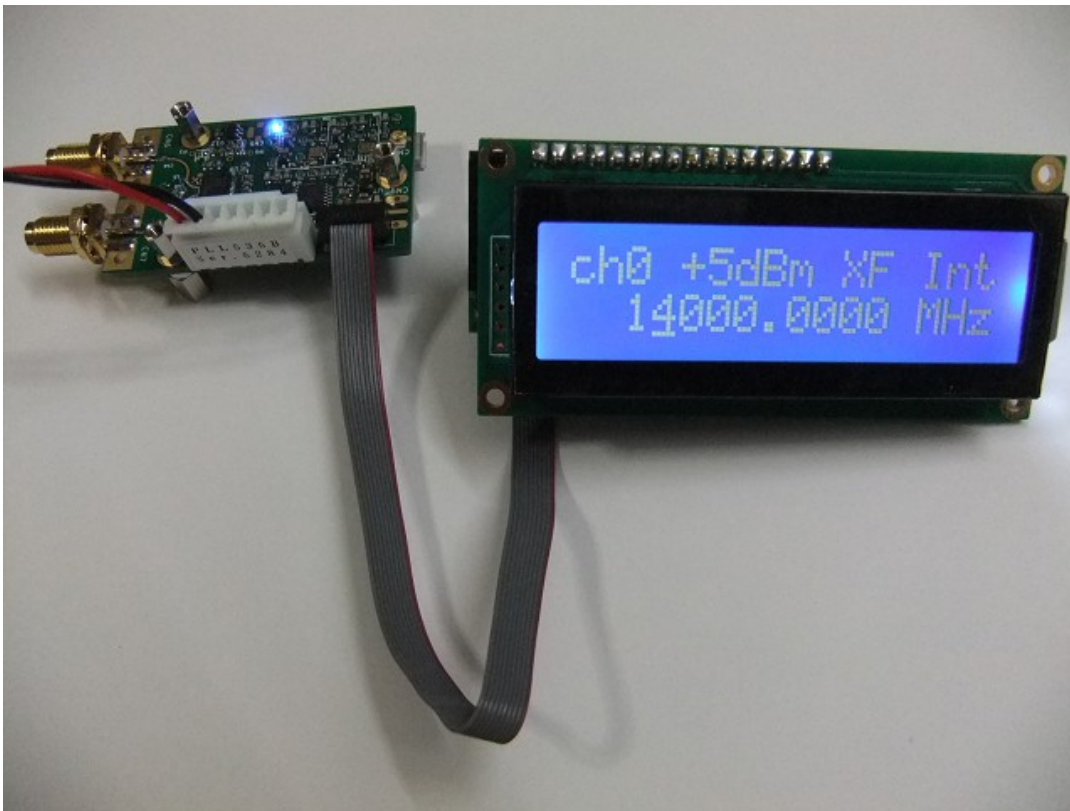
Fig.6 AUX5eとP-10185(ACM1602K-NLW-BBW)を用いた16桁2行での表示例。表示モード(表示器コード)=1
