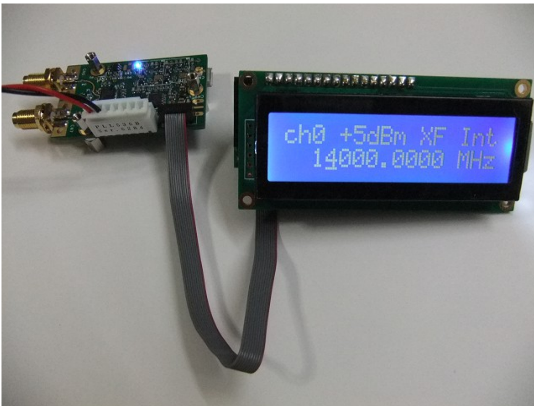
Fig.6 AUX5eとP-10185(ACM1602K-NLW-BBW)を用いた16桁2行での表示例。表示モード(表示器コード)=1
